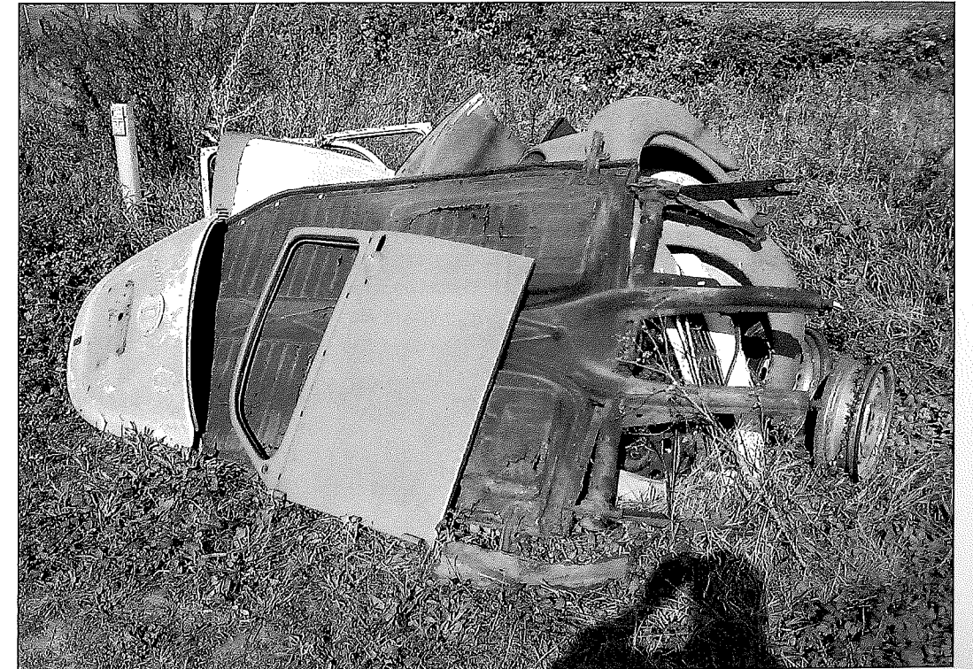
De aansluiting van de rechterdeur met het achterpaneel. De passing begint ergens op te lijken.
