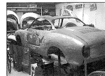
De linker zijkant kaalgeschuurd. Inmiddels hoopt er zich een grote partij plaatwerk op van andere projecten...
