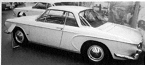
De gebogen taillelijn in het achterscherm, die uiteindelijk recht werd uitgevoerd.
