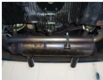
Een Duitse Karmann, waarbij later een katalysator is ingebouwd. Deze zit links geïntegreerd in de uitlaatpot.
