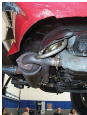
Hier zichtbaar de lambda-sonde aan de inlaatzijde van de (ongeregelde) katalysator. Duidelijk zichtbaar is ook de aanpassing in het plaatwerk onder achterklep om plaats te bieden aan de uitlaat en katalysator.
