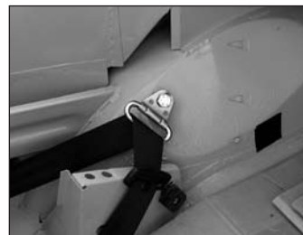
Bevestiging van het draaipunt op het achterste binnenscherm met een originele VW-plaat met moer (niet zichtbaar).
