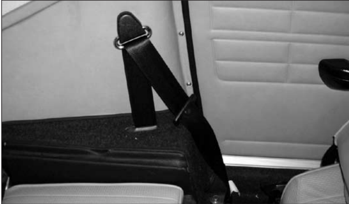
De gemonteerde gordel, met de rolautomaat netjes verborgen onder het zijvlak naast de achterbank zitting.
