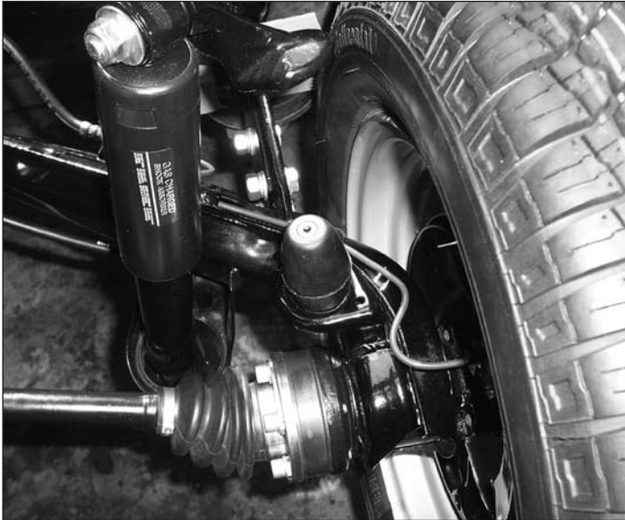
Detailfoto van de achteras van het tentoongestelde chassis
