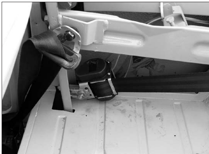
De rolautomaat voor de achterpassagier op de versterking van de B-stijl.
