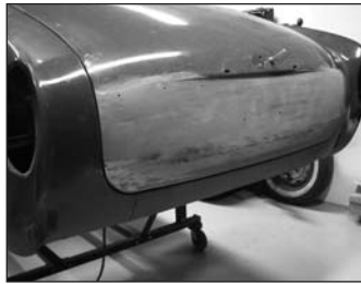
Het eindresultaat na alle schuur en slijpbe- werkingen.
