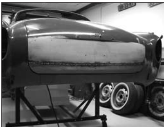
Nu is de klep geheel afgelast en past nog steeds goed inde carrosserie.
