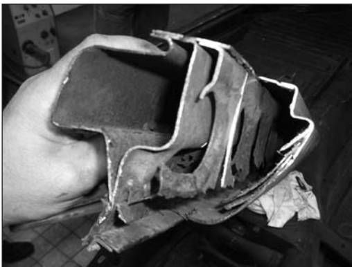
Stukje koker dat van dit resto-project afkomt. Let op de 3 dubbele 'gebakken' buitenplaat! Ook is de cabrio-versterkingsplaat gedeeltelijk 'opgelost'. Helaas is dat nooit zichtbaar vanaf de buitenkant...
