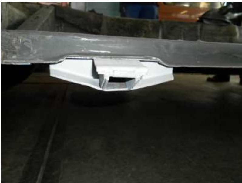
nieuwe vloerplaat met stoelrail
