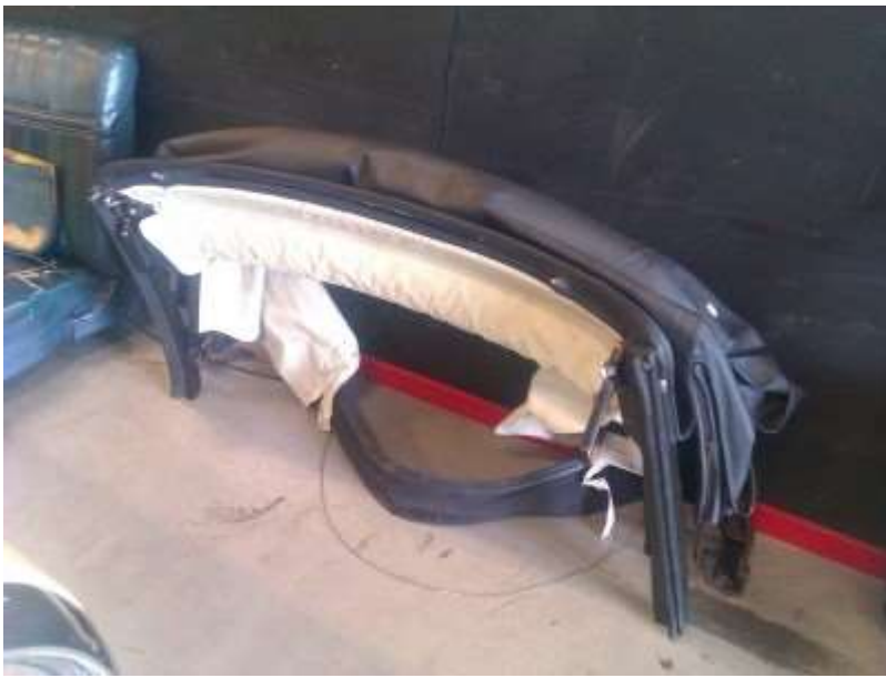
de kap wordt opnieuw bekleed
