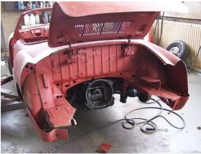
9 februari 2012 Achterzijde flink ontmanteld voor "nieuw" plaatwerk.
