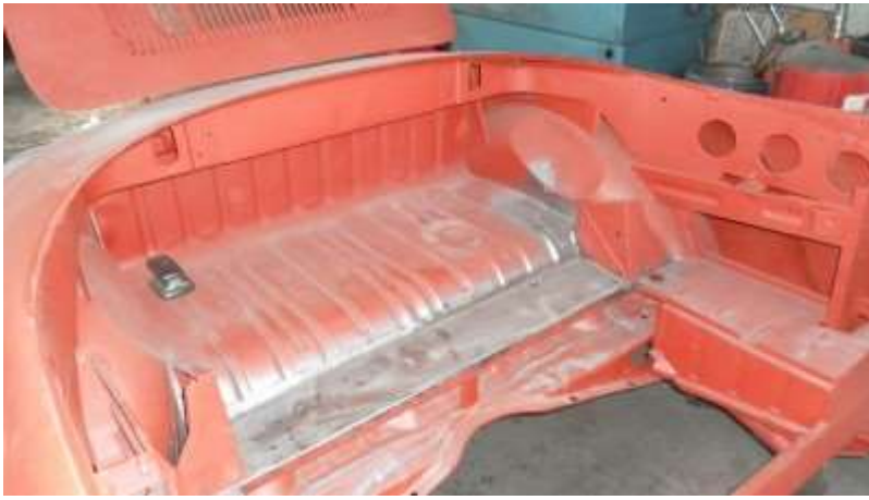
20 oktober 2011 kattenbak na het stralen en lassen
