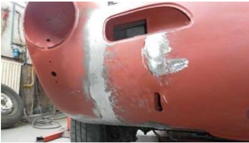
3 februari 2012 rechtsvoor gelast, gladgeslepen en behandeld
