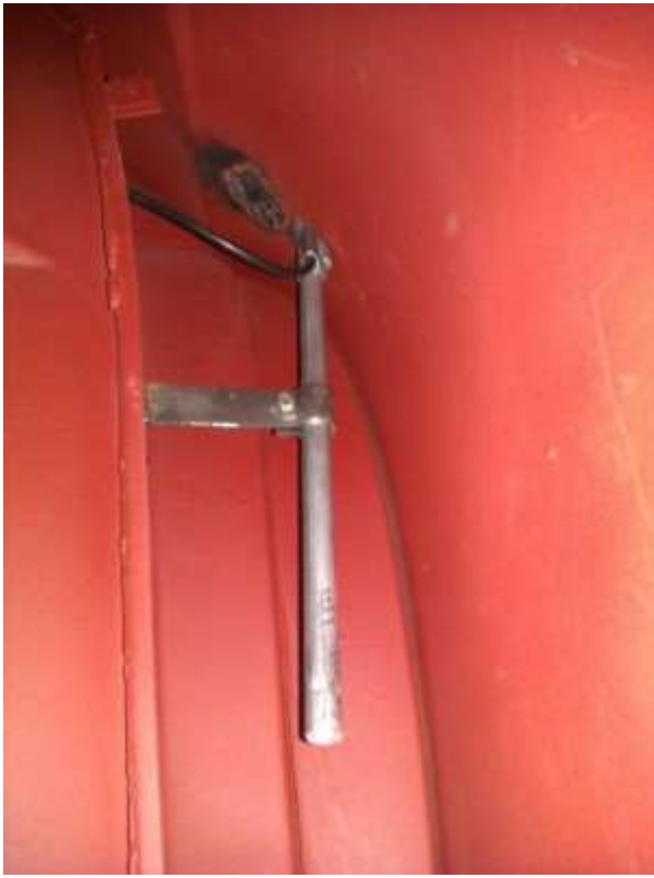
Henny heeft een speciaal beugeltje gemaakt voor de antenne te bevestigen
