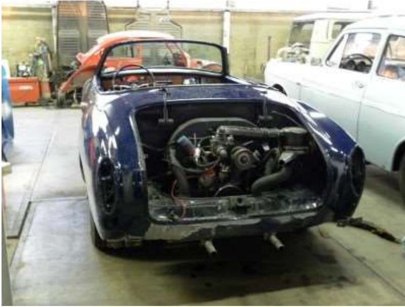
20 oktober 2011 kattenbak na het stralen en lassen
