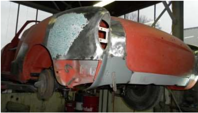
9 februari 2012 Achterzijde flink ontmanteld voor "nieuw" plaatwerk.
