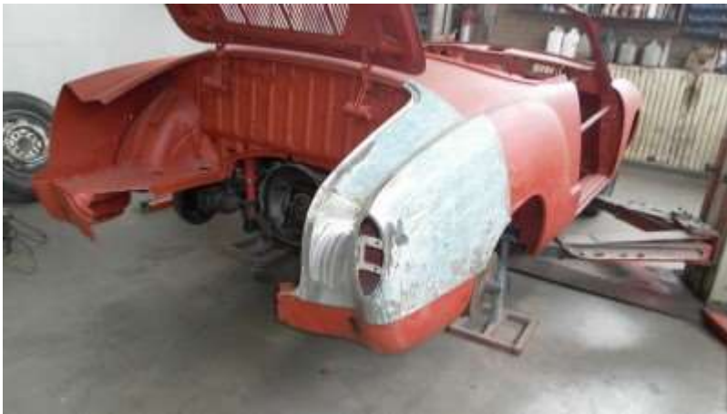
3 februari 2012 rechtsvoor gelast, gladgeslepen en behandeld
